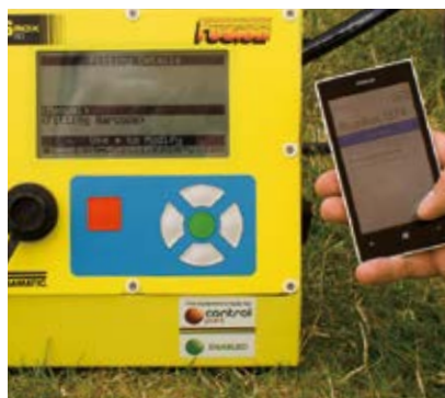
預裝ControlPoint軟件，通過智能手機與ControlPoint的PE焊接專家團隊建立聯系
