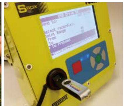
焊接數據可以通過USB接口下載，內存超過2000個接口紀錄
